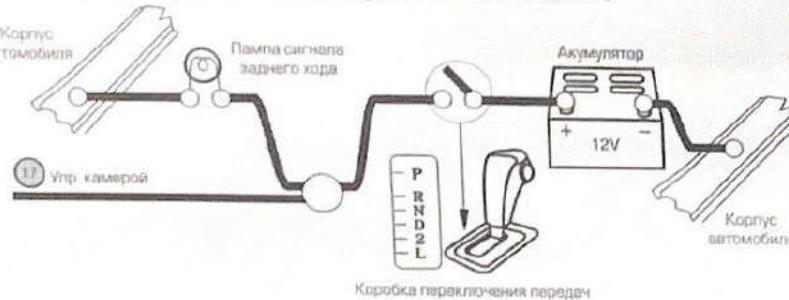
Если к устройству подключена камера заднего вида, то при включении передачи заднего хода автомобиль автоматически включается режим камера. После выключения передачи заднего хода устройство автоматически вернется к предыдущему режиму. Для этого провод ⑦ (BACK VIEW CONTROL) необходимо подключить к плюсовому проводу лампы сигнала заднего хода.
